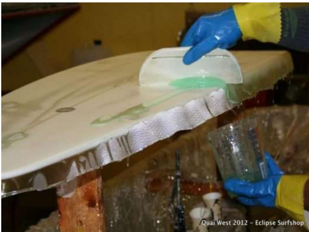
Pendant l'étape de stratification, la résine vient imprégner le tissu en fibre de verre posé sur la planche
