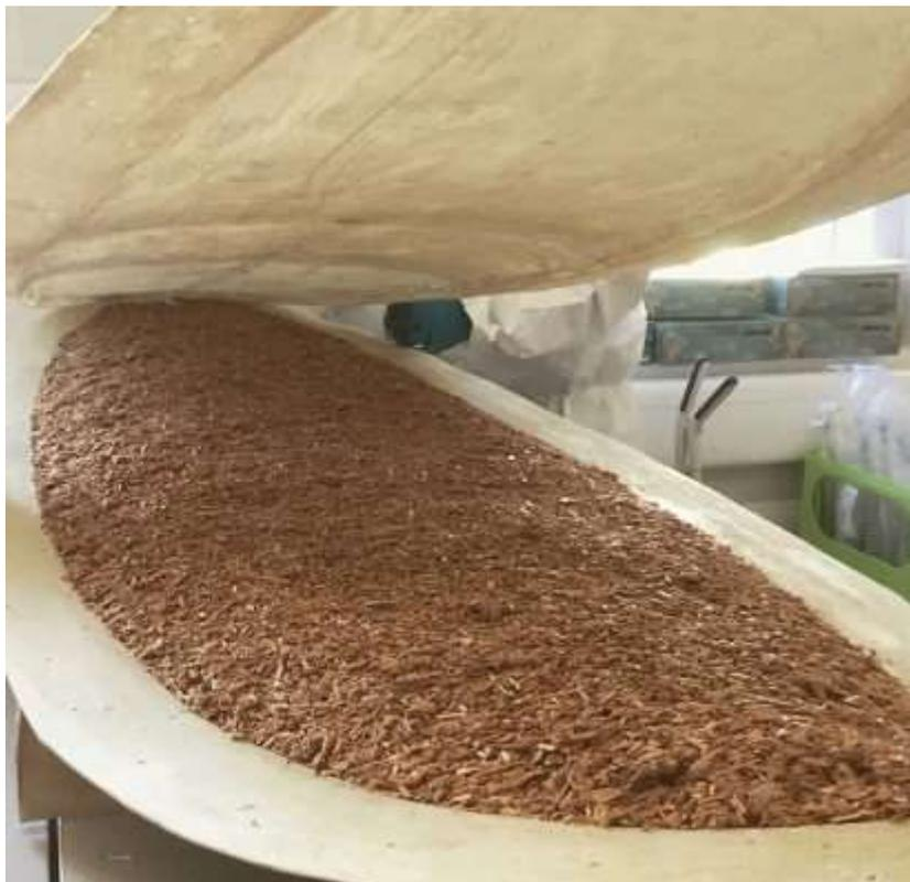
Moule d'une planche rempli de mycelium et de déchets agricoles
