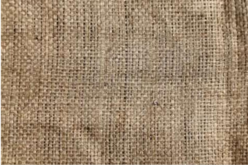
Tissu en fibre de lin pour remplacer la fibre de verre
